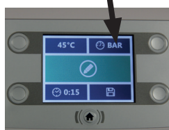
Pression ON (enclenchée)
